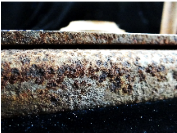
Figura 3. Aspecto original da corrosão da superfície.
