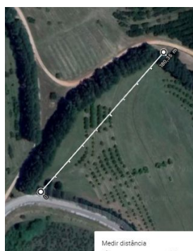
Figura 2. Distância máxima de comunicação dos módulos XBee S2C.
