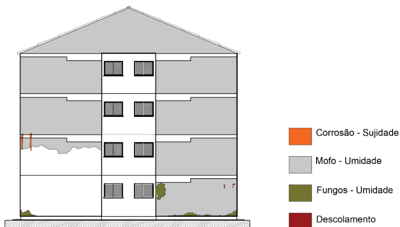
Figura 04: Manifestações patológicas encontradas na fachada através do levantamento fotográfico
