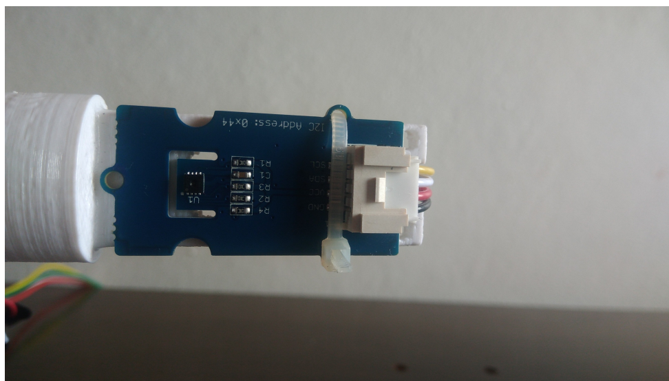
Figura 3 – sensor de temperatura SHT 31 com a estrutura de suporte no abrigo.
