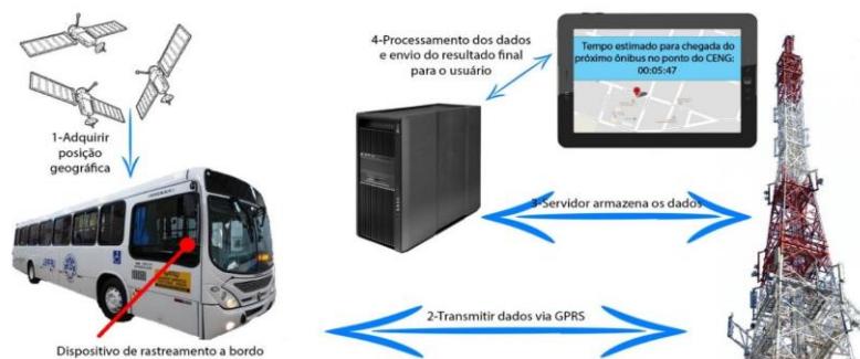
Figura 1. Fluxograma demonstrativo- Fonte: J.Peres et al. PROTÓTIPO DE BAIXO CUSTO DE UM RASTREADOR DEDICADO AO TRANSPORTE PÚBLICO . Pelotas,RS,2017.
