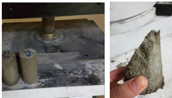
Figura 2 – Ensaio de resistência à compressão axial
