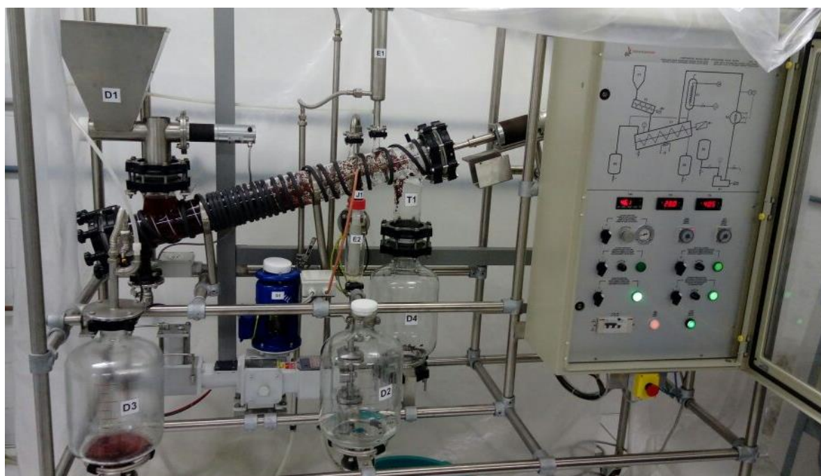
Figura 1. Planta piloto de extração contínua sólido-líquido.
