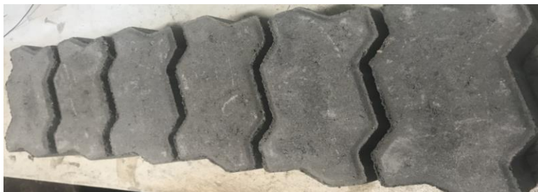
Figura 2 – Bloco de concreto com CCA
