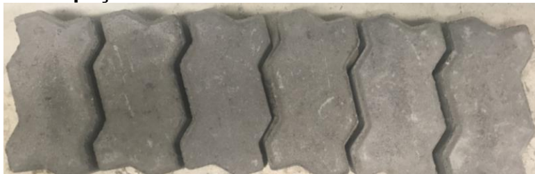
Figura 1 – Bloco de concreto sem CCA
