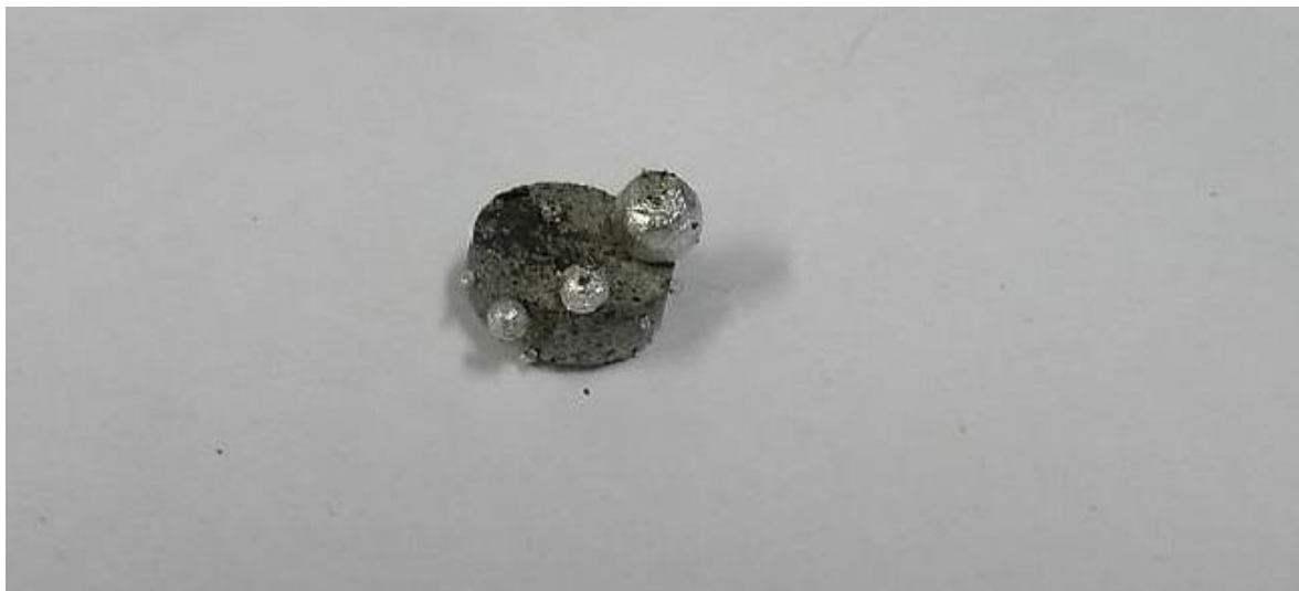
Figure 2: 92% Al + 8% NaBH 4 , tratada a 500°C por 15 minutos e em seguida em 700°C por 15 minutos.
