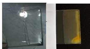
Figura 3: Filme depositado antes do tratamento térmico e depois do tratamento térmico. Imagem do próprio autor.
