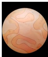
Figura 4: Primeira deposição do filme de \text{TiO}_2 no FTO observada do microscópio eletrônico com ampliação de x100
