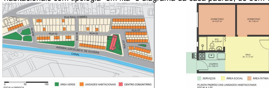
Figura 1 – Implantação do loteamento PAC/Anglo, com destaque as 90 unidades habitacionais com tipologia "em fita" e diagrama da casa padrão, de 36m 2 .
