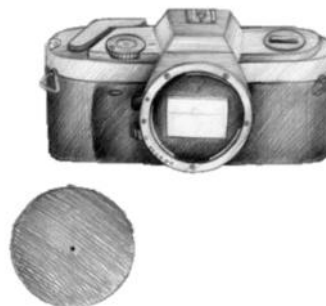
Figura 5: Esquema de adaptação de câmera convencional para pinhole.
