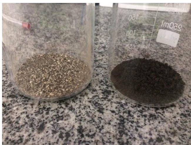
Figura 3- Comparação da lignina precipitada (esquerda) para a lignina lavada (direita)
