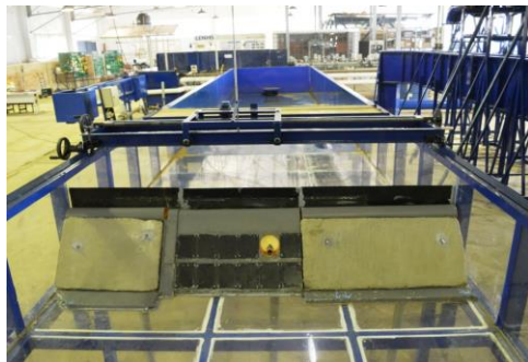
Figura 1. Vista de frente do modelo com descarga de fundo aberto na posição 12. Fonte: SARAIVA, 2017.
