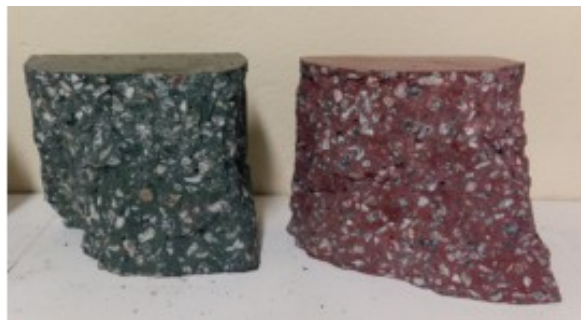
Figura 2. Verificação da homogeneidade interna dos CP's após rompimento.
