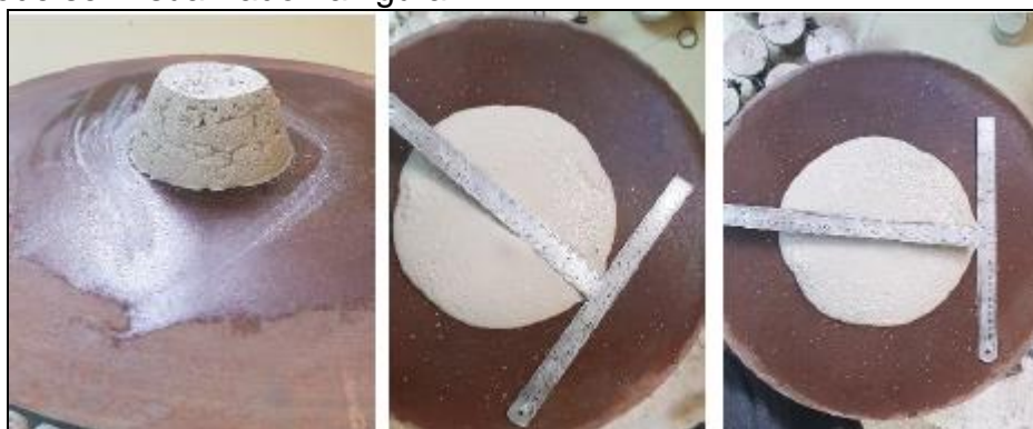
Figura 2 – determinação do índice de consistência das argamassas.
