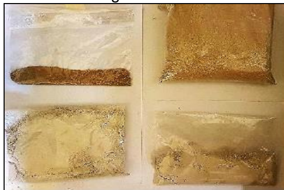
Figura 1 – reconstituição de traço argamassa industrial.
