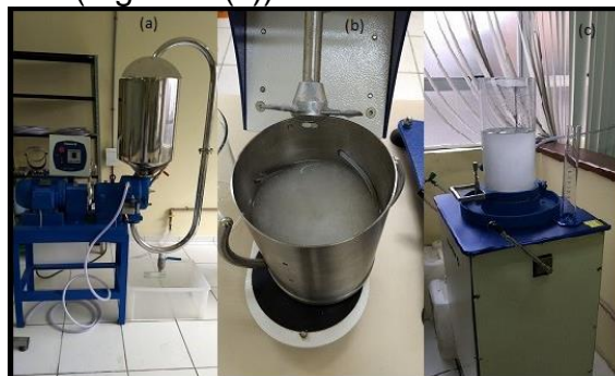
Figura 1 – (a) Refinador, (b) desintegrador e (c) formador de folhas.
