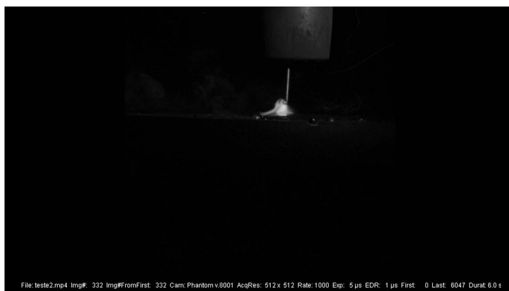
Figura 3 – Imagem obtida da câmera com foco na tocha de soldagem
