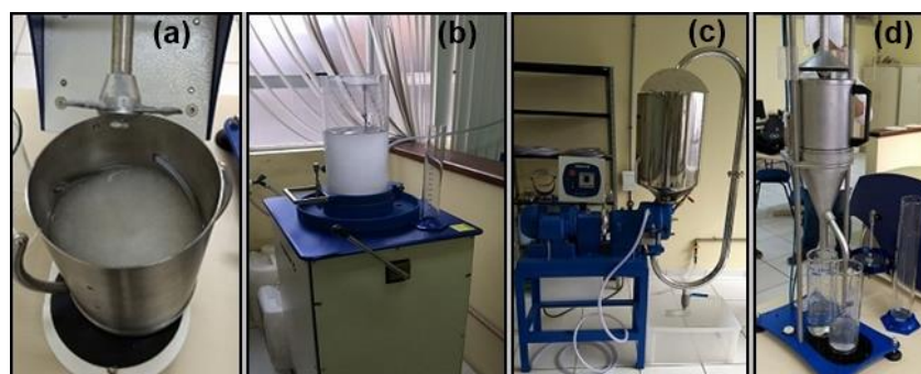
Figura 1 - Equipamentos utilizados. a) desintegrador; b) formador de folha; c) refinador; d) Schopper Riegler.
