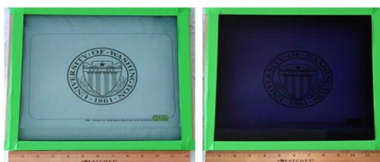
Figura 1. Fotos da janela eletrocrômica de WO 3 com estado descolorido (à esquerda) e colorido (à direita) (KIM, 2013).
