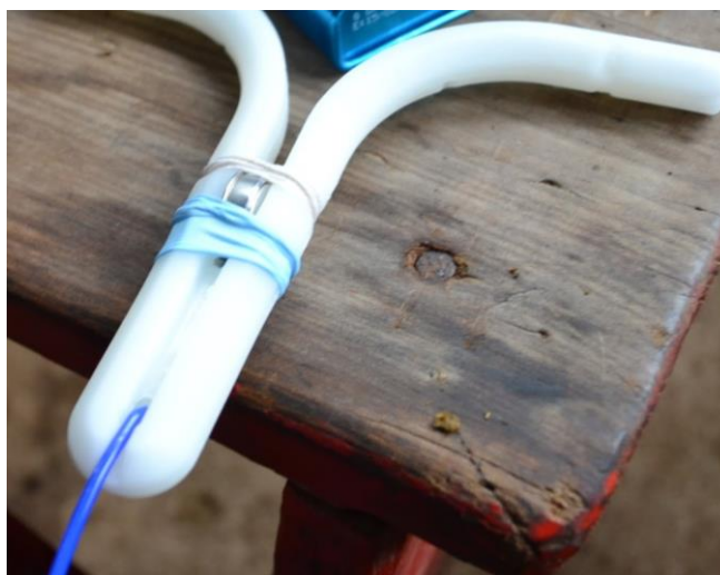
Figura 2 Termômetro data logger (iButton®,Thermochron, Whitewater, USA), acoplado ao dispositivo intravaginal.
