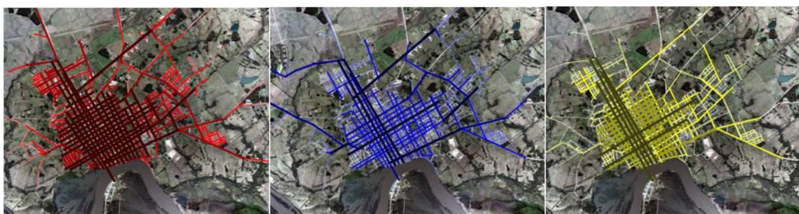
Figura 4 - Mapas axiais da cidade de Jaguarão-RS com análise, da esquerda para a direita, de acessibilidade, centralidade e conectividade.
