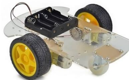
E) O kit Chassi 2WD Robô
