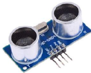
D) O sensor de distância ultrassônico HC-SR04
