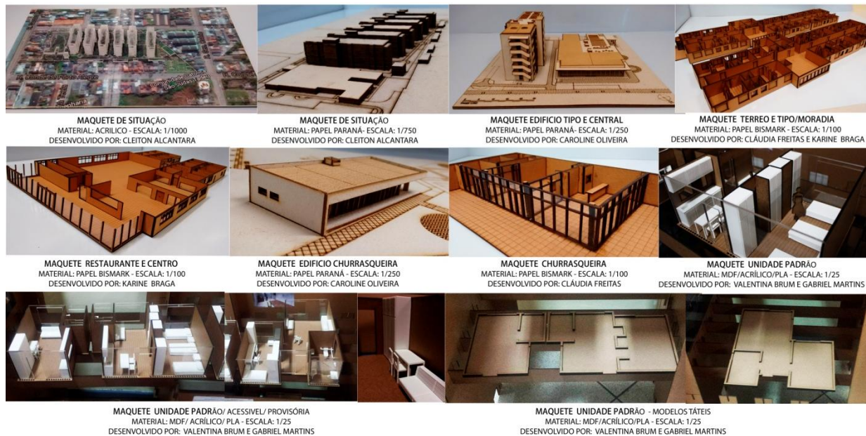
Figura 1 – Maquetes produzidas por corte a laser e impressão 3D.
