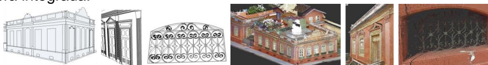
Figura 1 – Representações em perspectiva do Casarão 8, à esquerda obtidas a partir da documentação por levantamento tradicional e à direita a partir da nuvem de pontos obtida por escaneamento 3D.
