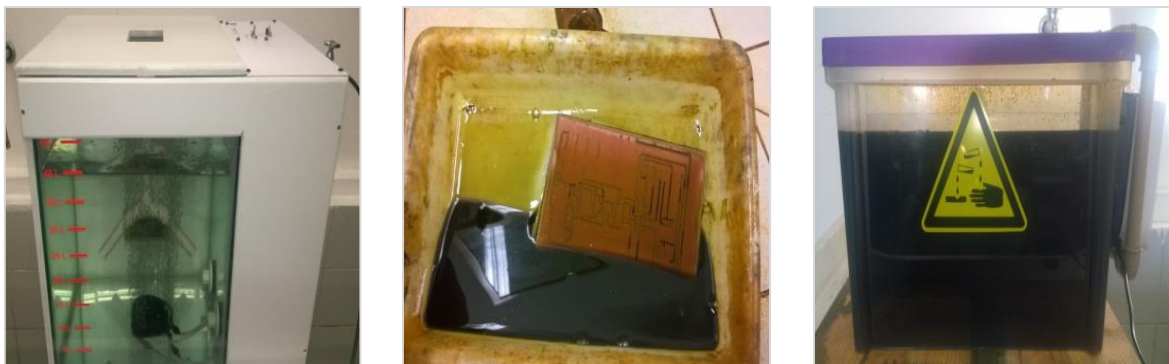
Figura 1: (a) tanque acelerador de corrosão; (b) método tradicional, e (c) tanque vertical
