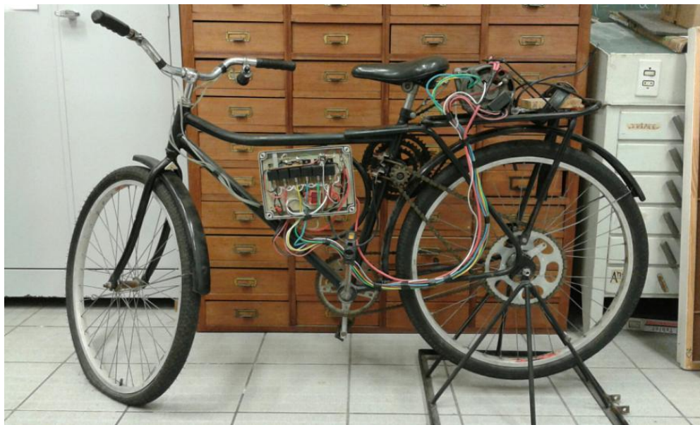
Figura 1: Bicicleta utilizada pelo grupo de pesquisa para a geração de energia elétrica Fonte: o grupo
