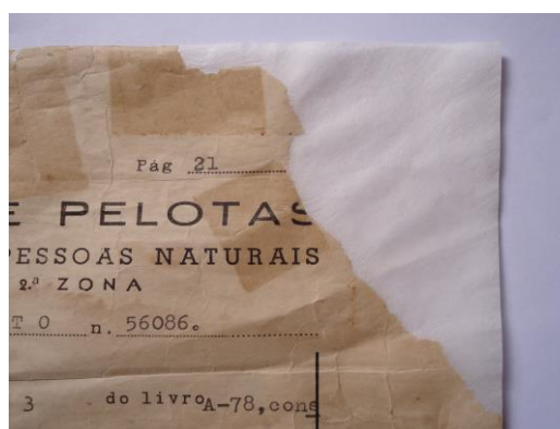
Figure 2: Detalhe de reintegração de borda com papel japonês realizada no documento. Fonte: Fernanda Rodrigues, 2016.
