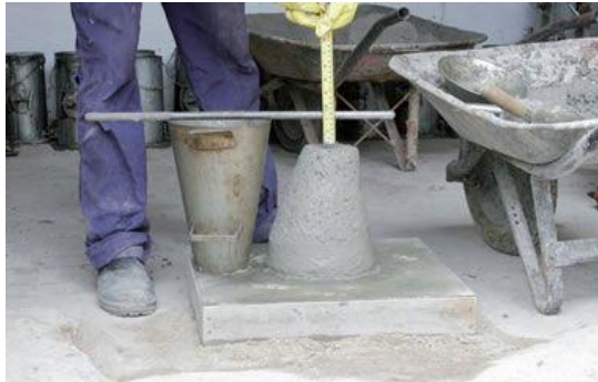
Figura 3 – Teste de abatimento de tronco de cone – Slump teste – NBR
