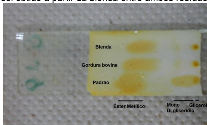
Figura 1 – Placa de cromatografia em camada delgada de biodiesel de resíduo de óleo de fritura (padrão), do biodiesel de gordura bovina pura e do biodiesel obtido a partir da blenda entre ambos resíduos.
