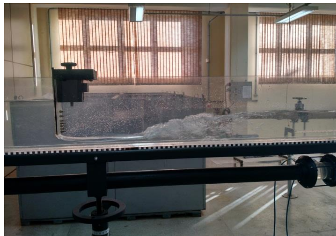
Figura 1 - Ressalto hidráulico no canal didático utilizado no experimento.
