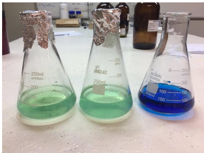
Figura 2- Soluções de azul de metileno após remoção do corante utilizando lignina (Fracos 1 e 2) e solução inicial de azul de metileno 20mg/L (frasco 3).
