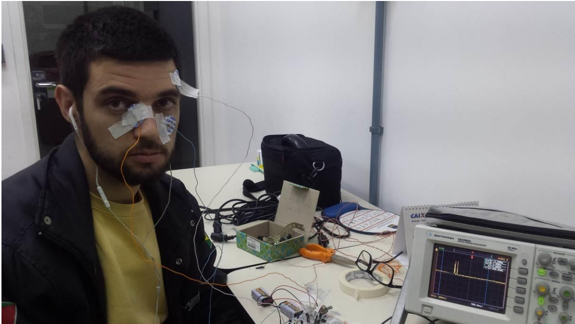
Figura 1 - Henrique da Silva Couto realizando os primeiros testes do sistema de EOG. Observa-se no osciloscópio a detecção das piscadas.
