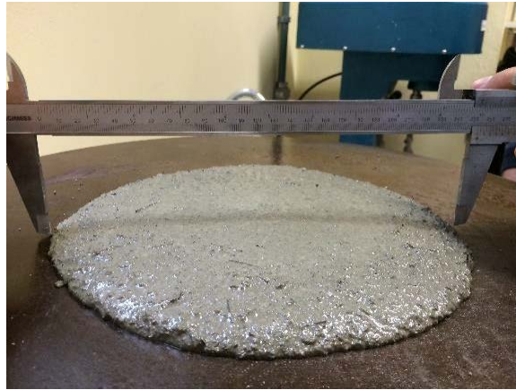
Figura 02 - Medida do espalhamento da argamassa
