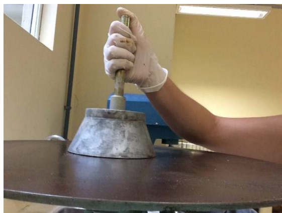
Figura 01 - Colocação da argamassa dentro do molde tronco-cônico
