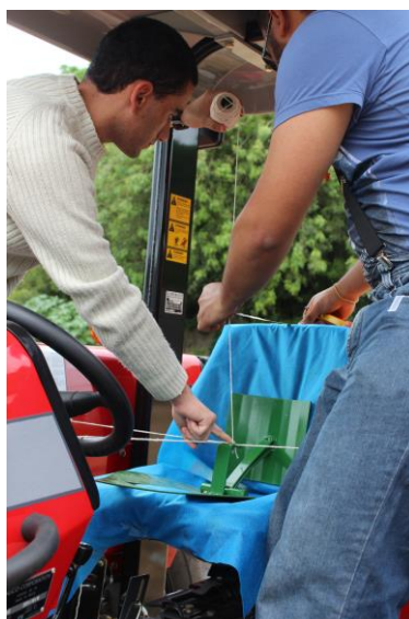
Figura 2 - Dispositivo para a determinação do SIP posicionado sobre o assento de um posto de operação amostrado
