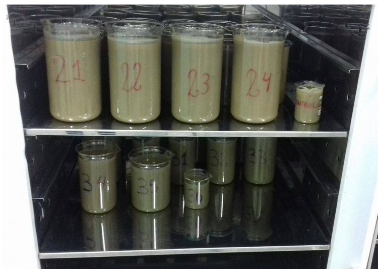
Imagem 1: Secagem do lodo em estufa
