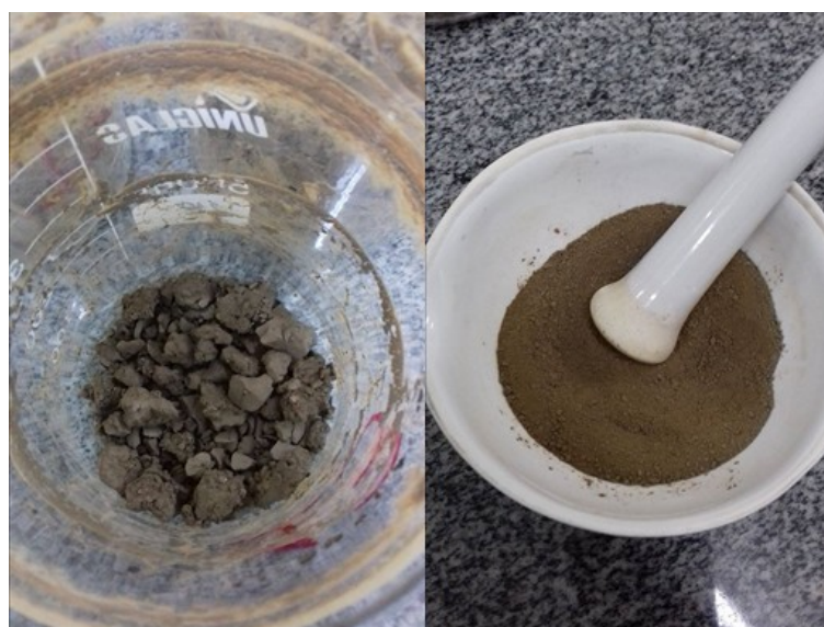
Imagem 2: Lodo pós secagem e pós triturado
