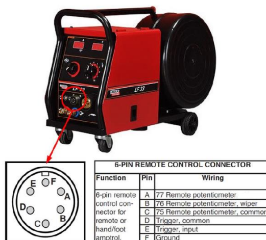
Figura 3 – Alimentador de arame LF-33 e as características do controle remoto.
