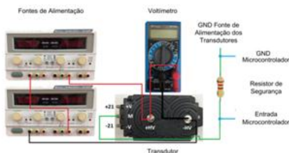
Figura 2 – Disposição dos equipamentos para realização dos ensaios de calibração do transdutor de tensão.
