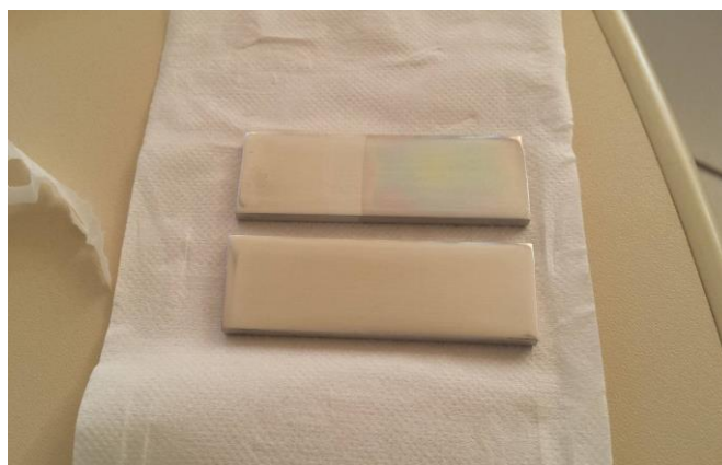
Figura 4 – Substratos de Alumínio: o superior com filme de sílica, etching de 2%HF e funcionalização; inferior apenas polido e limpo.
