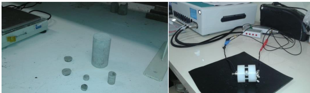
Figura 1- Corpos de Prova (a), Amostra acoplada no Autolab-PGSTAT 302N (b)
