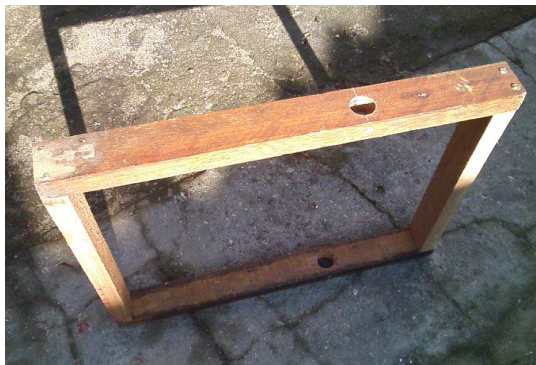
Figura 1. Quadro inferior para a base do alimentador
