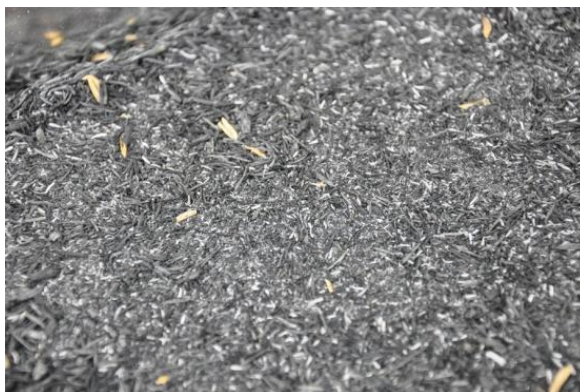
Figura 1 – Resíduo de cinza de casca de arroz (CCA). Fonte: autor (2015)
