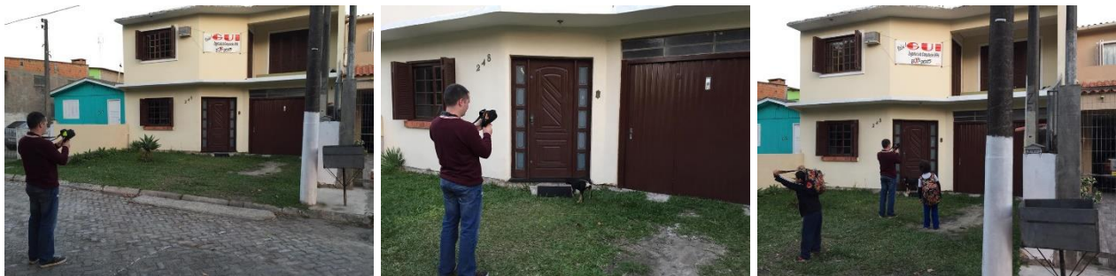
Figura 1a, b, c - Captação dos termogramas a 10, 5 e 3m de distância da fachada, respectivamente. Fotos do autor.
