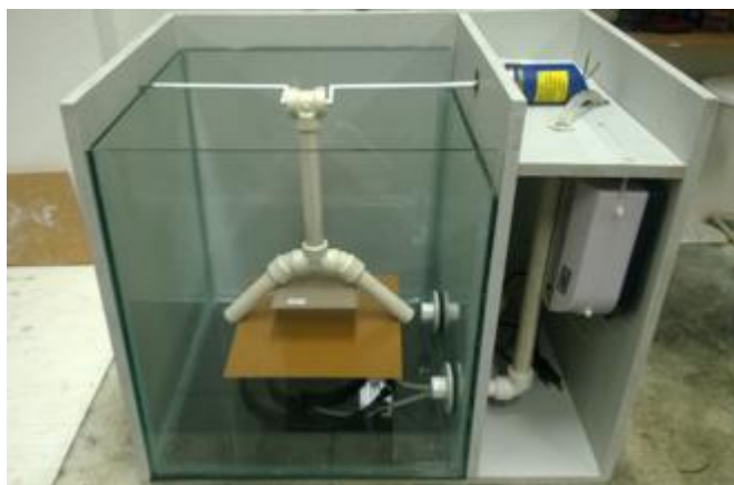
Figura 1: Tanque de corrosão em funcionamento no Atelier de Gravura do Centro de Artes da UFPel, 2015
