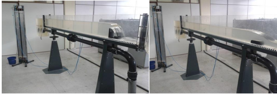
Figura (1) e (2): Canal Didático com fluxo sobre o Vertedor de Soleira Delgada na imagem à esquerda e de Soleira Espessa na imagem à direita.
