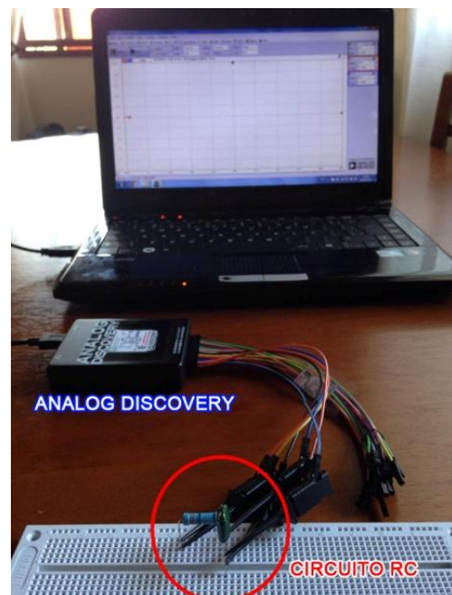
Figura 3 – Unidade experimental, formada por osciloscópio, gerador de funções e circuito RC.
