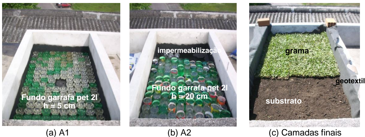
Figura 2 – Etapas de montagem do experimento: (a) Célula A1; (b) Célula A2; (c) etapas finais: substrato e vegetação. Fonte: Autores (05/11/2014).
