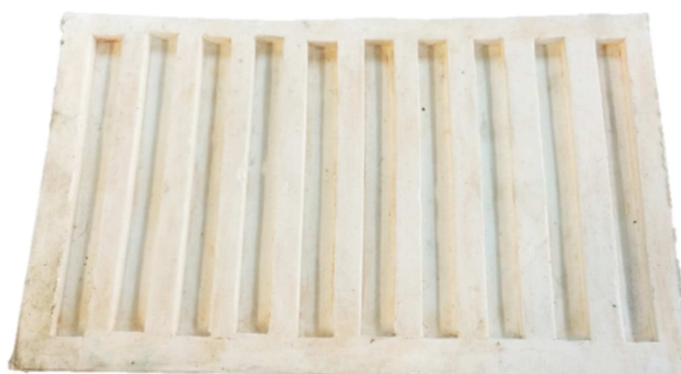
Figura 2 – Molde utilizado para a confecção dos corpos de prova analisados quanto à retração volumétrica.
