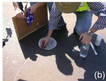
Figura 1. (a) Pêndulo Britânico empregado no estudo; (b) Aparato utilizado para realização do ensaio de Mancha de Areia.
