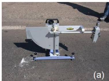
Figura 1. (a) Pêndulo Britânico empregado no estudo; (b) Aparato utilizado para realização do ensaio de Mancha de Areia.
