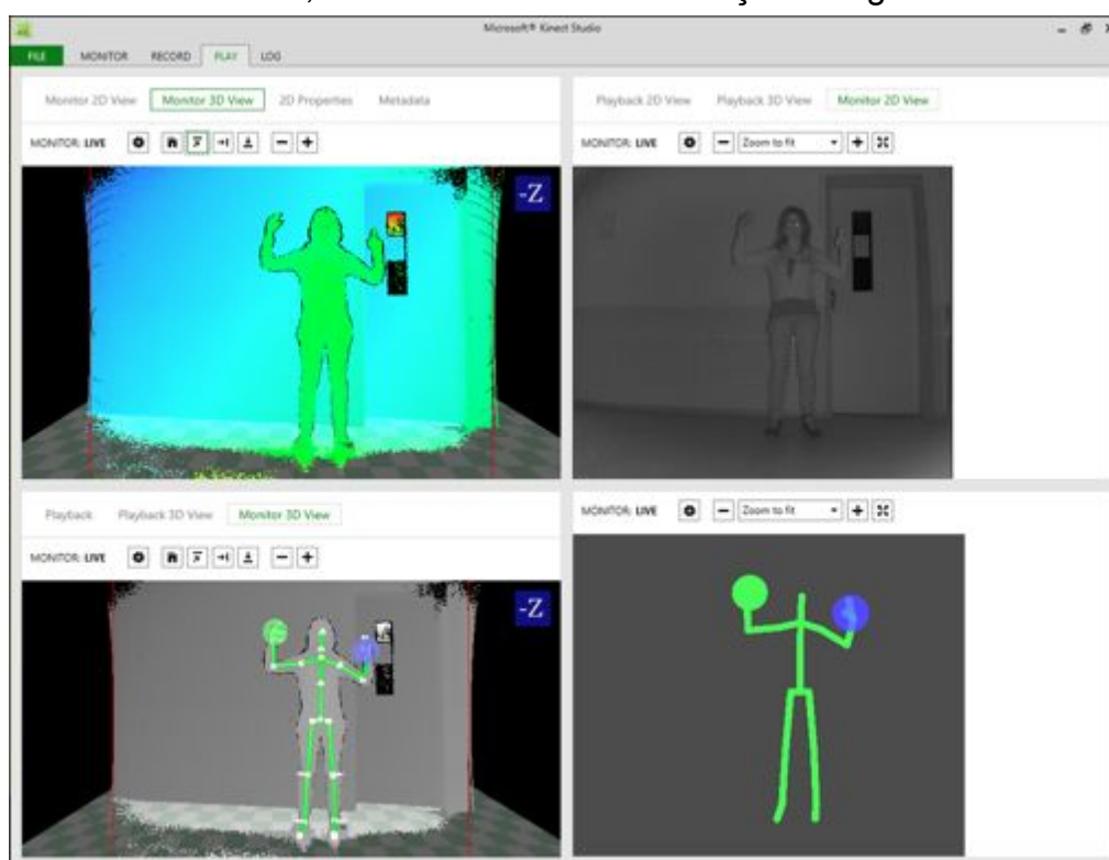
Figura 1 - Mapeamento do corpo com as visões de Color, Infrared, Body, e BodyIndex no Microsoft Kinect Studio™
